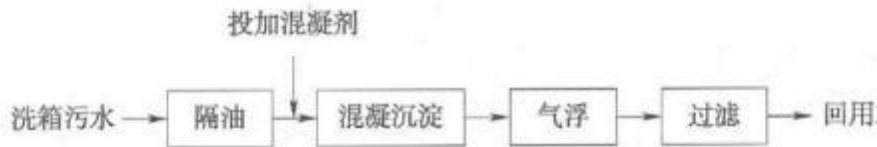
图2-2 集装箱冲洗水处理工艺示意图
